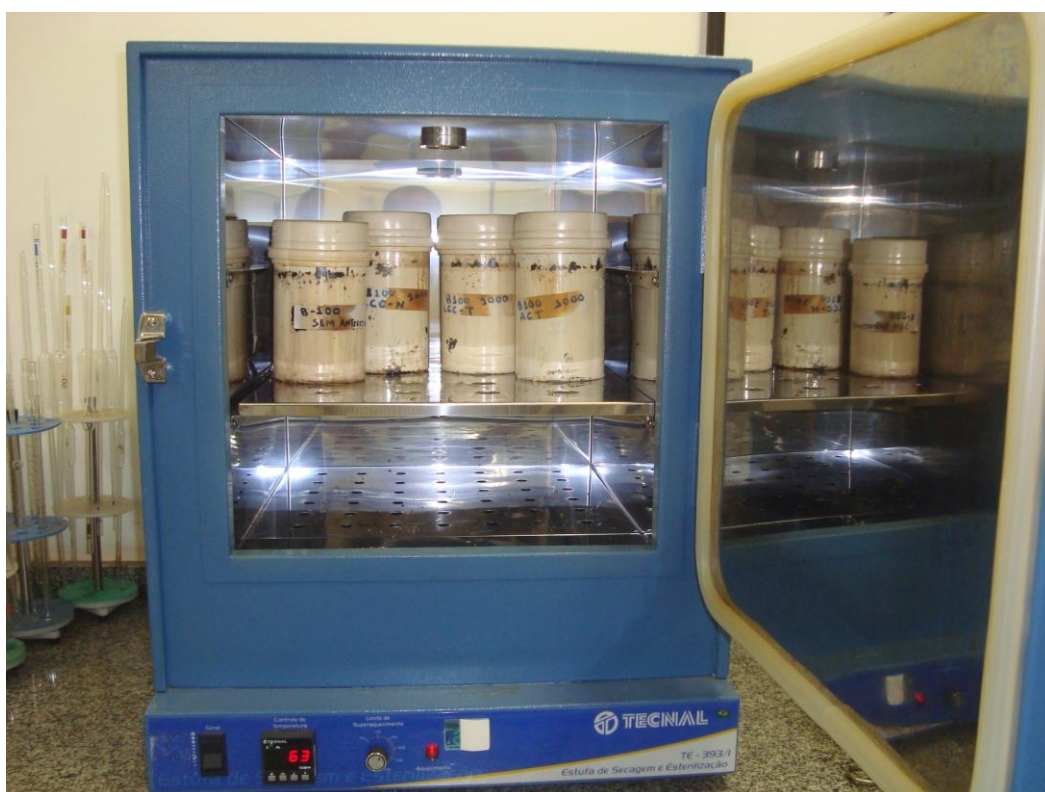
FIGURA 15 – Armazenagem das amostras em estufa. Foto: Danylo Mendes
