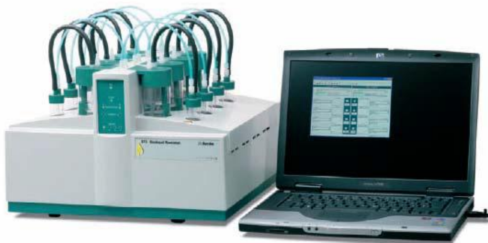
FIGURA 18 - Rancimat para biodiesel - Metrohm 873. Fonte: Figueiredo, (2009).
