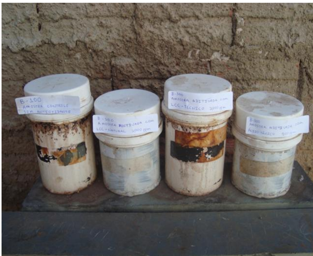
FIGURA 16 – Amostras expostas às condições ambientais por três meses.
