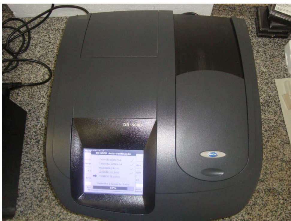
FIGURA 17 – Espectrofotômetro DR 5000. Foto: Danylo Mendes
