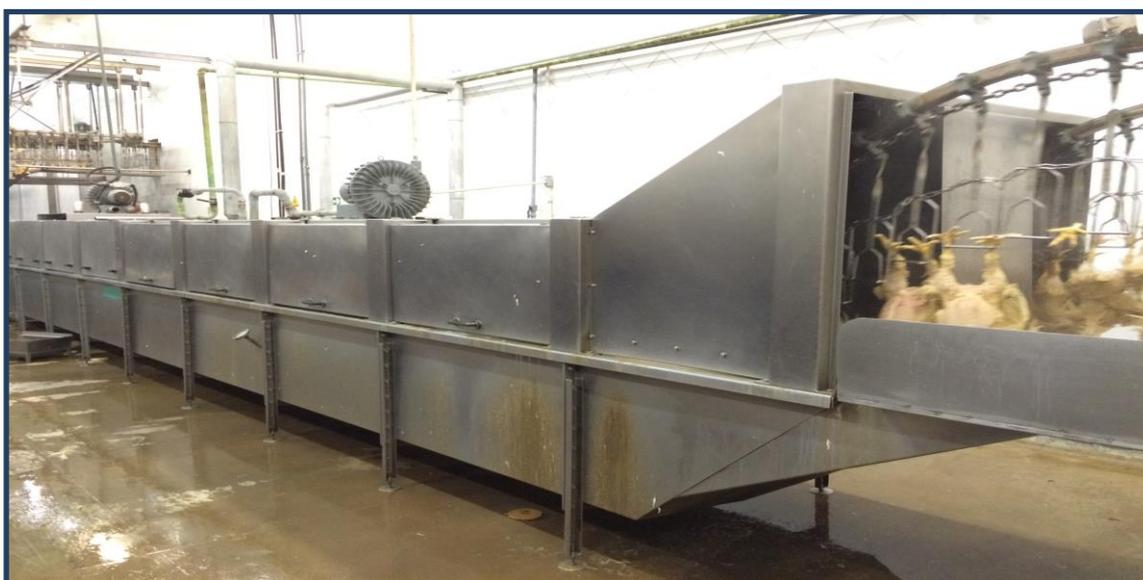
**Figura 09.** Procedimento de escaldagem de aves domésticas em abatedouro.
