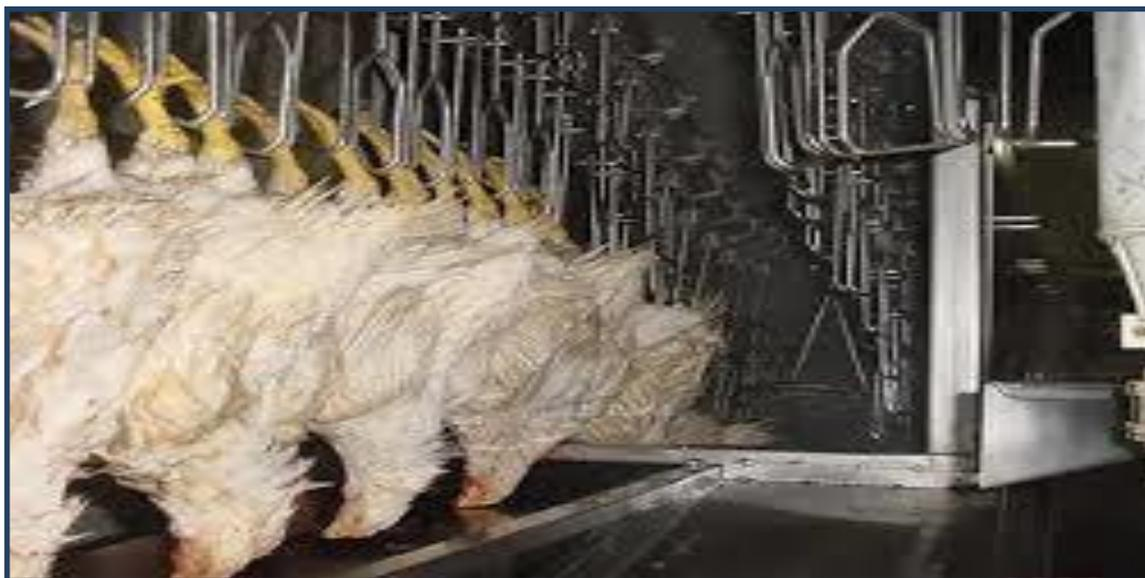
**Figura 07.** Processo de insensibilização por eletronarcose de aves de corte.
