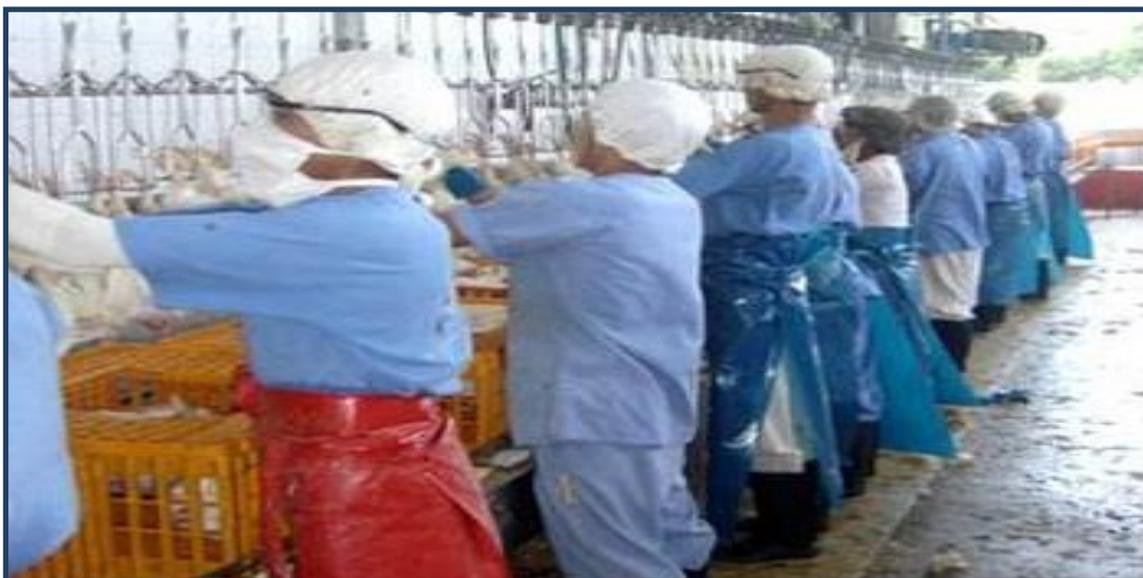
**Figura 06.** Procedimento de pendura e condução das aves até o procedimento de insensibilização.
