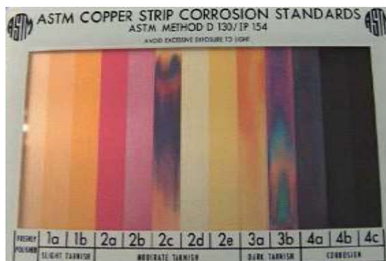
Figura 2. Referência de corrosividade ao cobre do método ASMT D130
