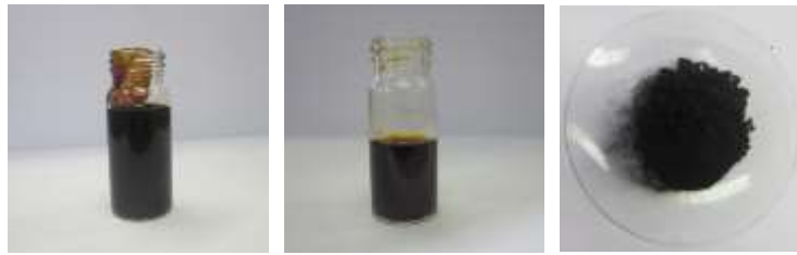
Figura 2. Frações de bio-óleo, aquosa e sólida, respectivamente, obtidas no processo de pirólise termocatalítica de lodo de esgoto
