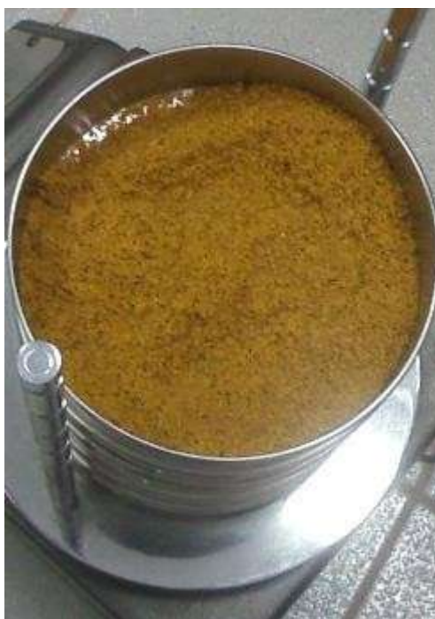
Figura 4: Peneiramento para separação de partículas por tamanho em tamisador (Foto: Adriana Borges)
