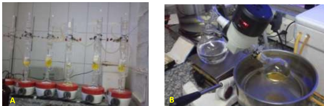
Figura 5: A. Extração de óleo da polpa de dendê via Soxhlet com solvente hexano e B. recuperação do solvente no evaporador rotativo (Foto: Adriana Borges)
