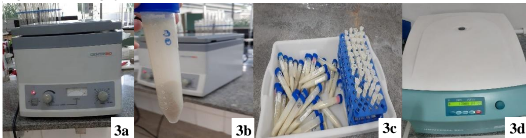
Figura 3 - Etapas de centrifugação para separação da parte solúvel e insolúvel, e em seguida centrifugação do sobrenadante.
