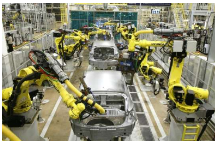
Figura 13: Robôs realizando solda em montadora e robô utilizado
