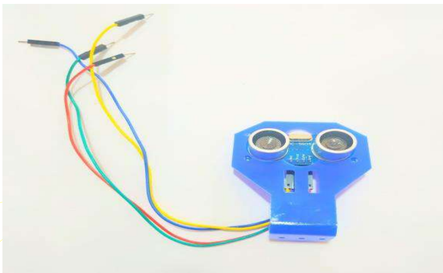
Figura 41: Sensor ultrassônico preso ao suporte plástico Fonte: próprio autor
