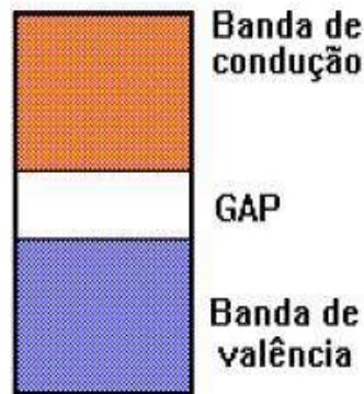
Figura 2.14: Banda de energia para o semicondutor.
