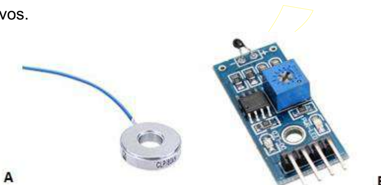
Figura 20: 20A Sensor Piezoelétrico e 20B Sensor Térmico para Arduino Fonte: http://labdegaragem.com/profiles/blogs/tutorial-como-utilizar-o-piezo-element-com-arduino
