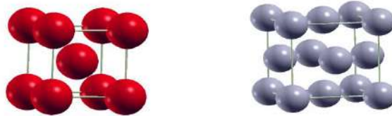
Figura 2.4: Células unitárias cúbicas de silício Fonte: Próprio Autor
