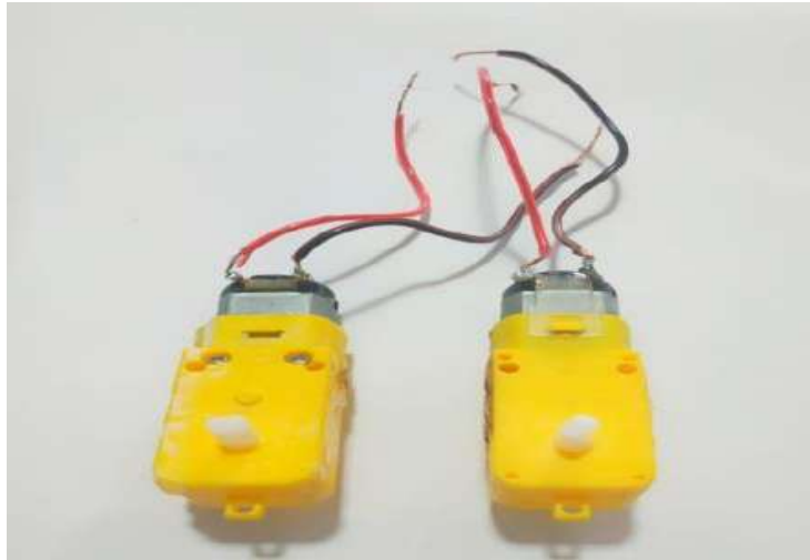
Figura 34: Motores de corrente continua Fonte: próprio autor
