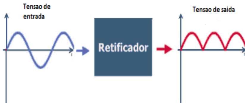
Figura 2.19: Tensões de entrada e saída em um diodo retificador
