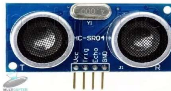
Figura 3.13: Sensor ultrassônico (Ativo)
