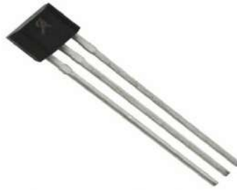
Figura 2.9: Sensor de Efeito Hall linear A1302
