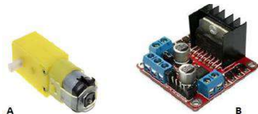
Figura 26: (26A) Motor de corrente contínua com caixa de redução. (26B) Ponte H (circuito de potência) utilizado para o controle da polaridade do circuito.
