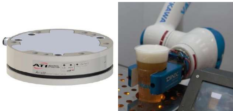
Figura 3.15: Sensor de Torque ATI produzido pela Direct Industry e ao lado um braço robótico executando movimento de alta precisão.
