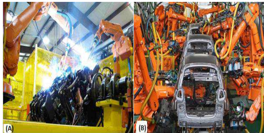
Figura 3.1: Item A robô utilizado em solda e item B robôs realizando montagem.
