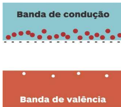
Figura 2.16: Banda de energia para o condutor tipo N.
