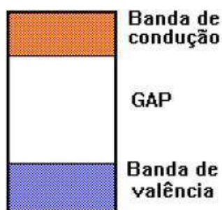
Figura 2.12: Banda para um isolante
