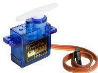
Figura 23: Servo motor tipicamente utilizado em atividades de robótica educacional Fonte: https://www.vidadesilicio.com.br/quickview/index/view/id/50
