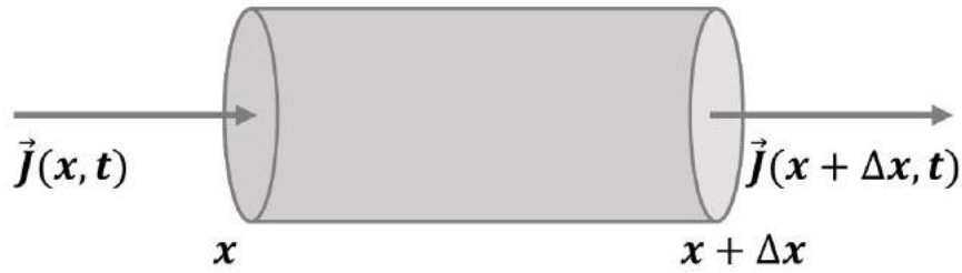
Figura 4.1: Fluxo de calor através de um cilindro elementar com as paredes laterais isoladas e o eixo ao longo da direção x
