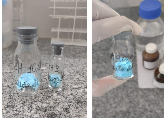
Figura 12 - Cristais formados de sulfato de cobre penta-hidratado.
