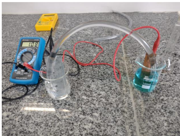
Figura 15 - Célula voltaica que usa uma ponte salina para completar o circuito elétrico, esquema montado em aula prática.
