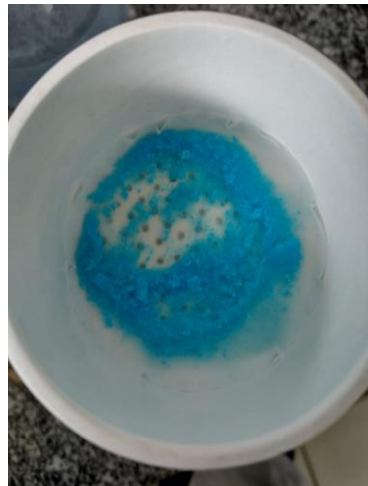
Figura 11 - Cristais de sulfato de cobre sendo filtrados.
