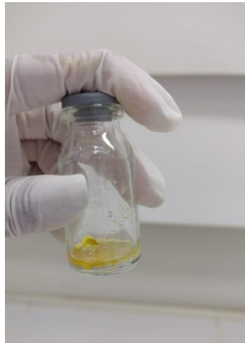
Figura 16 - Adição de ácido clorídrico no precipitado (AgCl e Ag 2 CrO 4 ).
