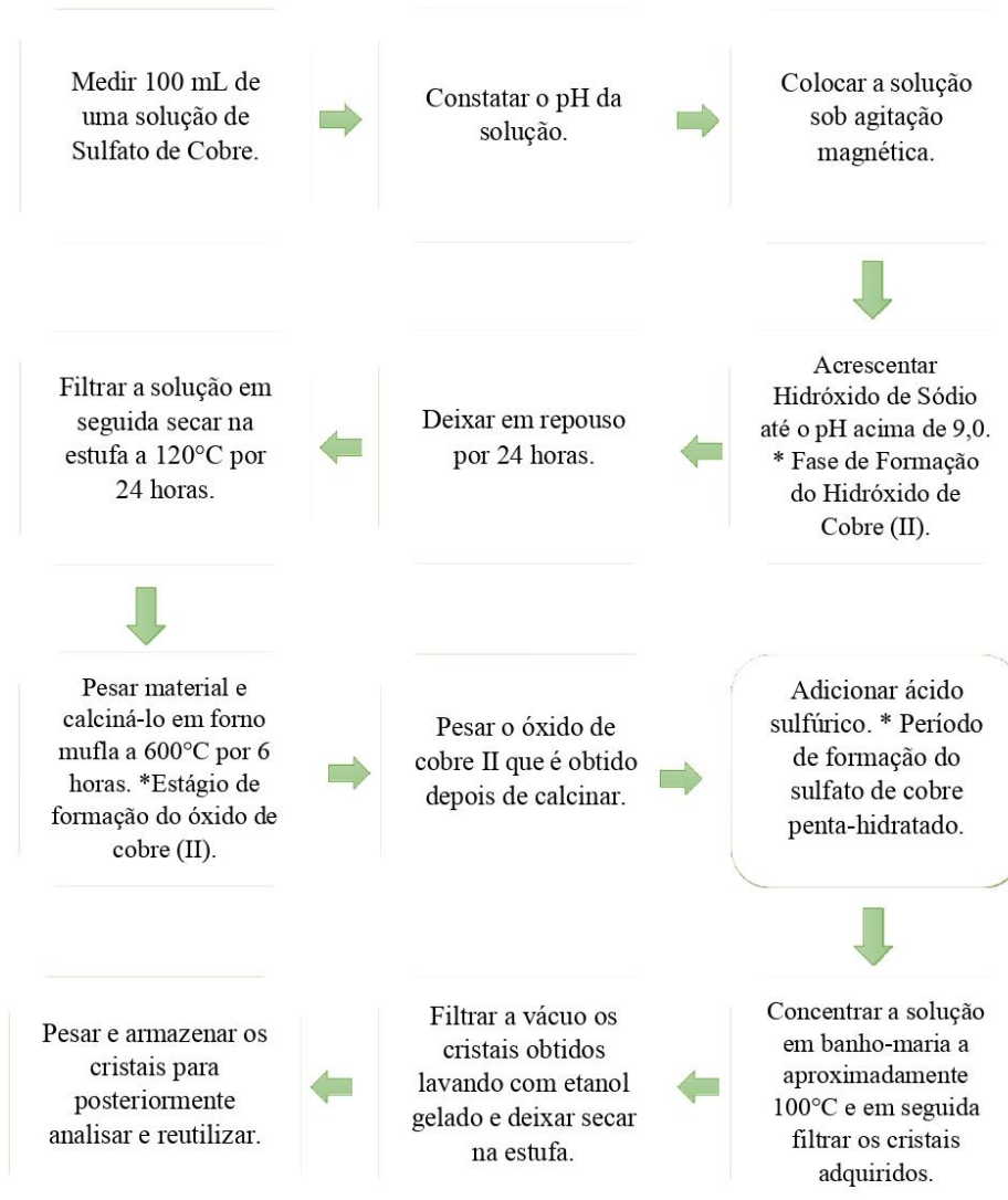
Figura 1 - Fluxograma contendo o processo de tratamento do resíduo de cobre.
