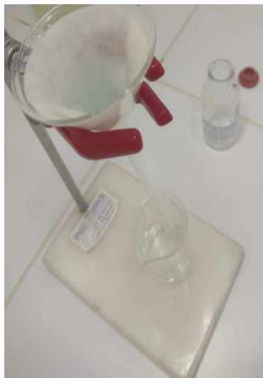
Figura 21 - Filtração simples do precipitado formado.
