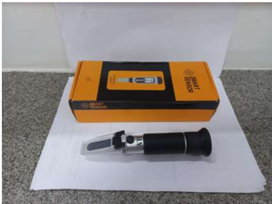
Figura 9 – Sistema de análises de sólidos solúveis - °Brix.
