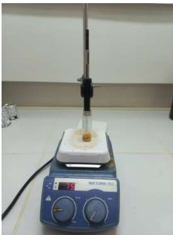
Figura 10 – Sistema de micro extração em fase sólida do HS-SPME .
