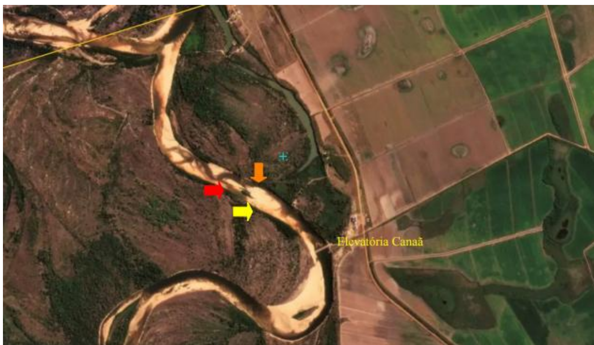
Figura 10 – Nível crítico do leito do Rio Formoso a jusante da Barragem Canaã: imagem do satélite Planet Scoop (Planet Labs Inc.) de 16 ago. 2021
