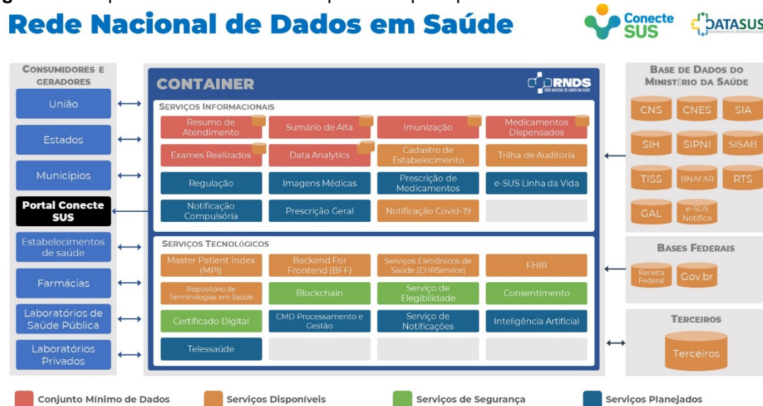
Figura 6 – Esquema conceitual dos componentes principais da RNDS
