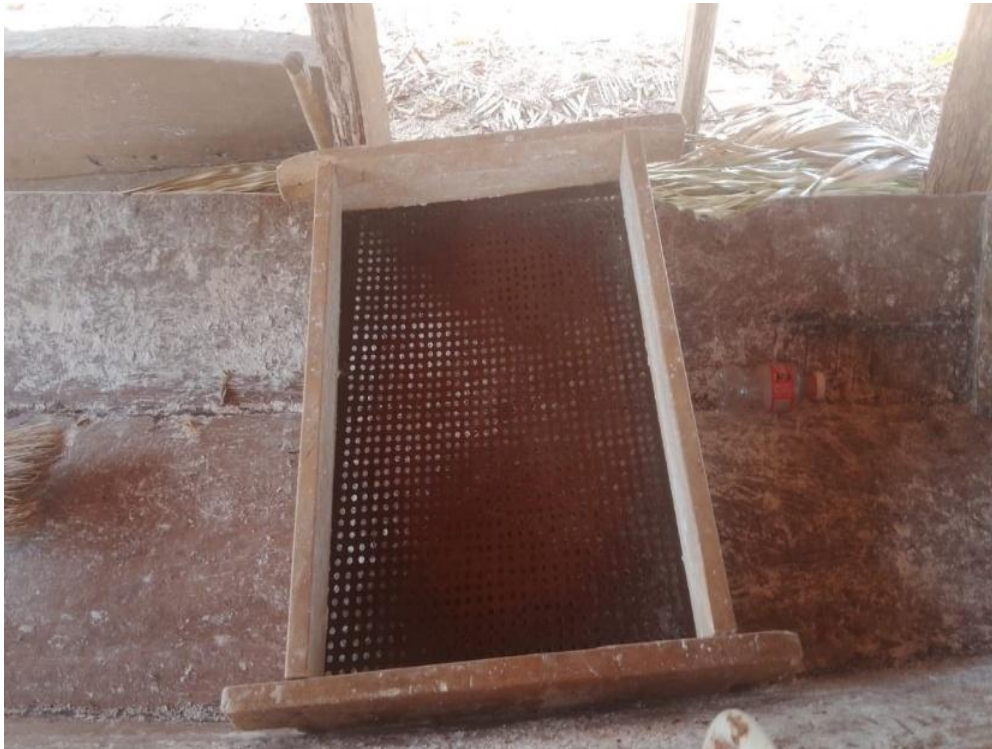
Figura 9 – Peneira feita com a palha de buriti
