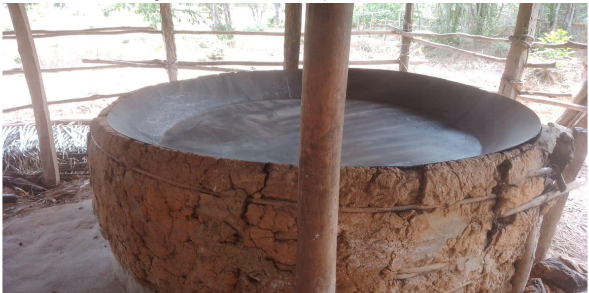
Figura 5 – Forno utilizado para torrar a farinha
