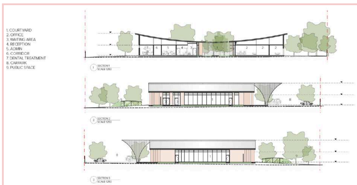
Figura 16 – Planta de corte, a altura do edifício e a relação do mesmo com o átrio central..
