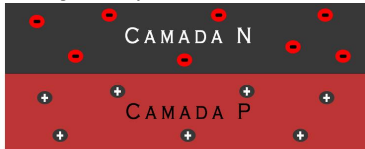
Figura 3: Junção de duas camadas de silício
