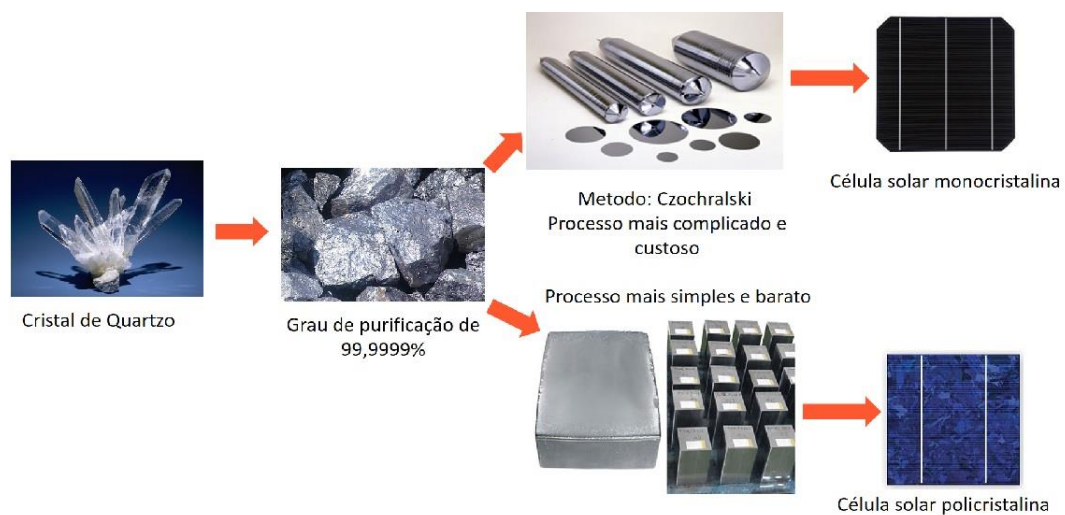
Figura 9: Processos de Fabricação da Célula Fotovoltaica de Silício
