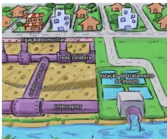
Figura 4 - Rede de esgotamento sanitário
