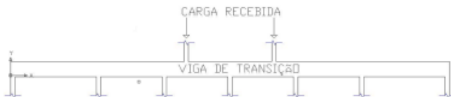
Figura 3 – Esquema estrutural de uma viga de transição.
